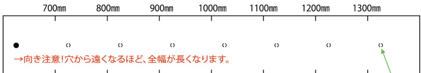
全幅600mmのときはこの棒は使用しません。全幅1400mmのときはカットをせずにそのまま使用します。
